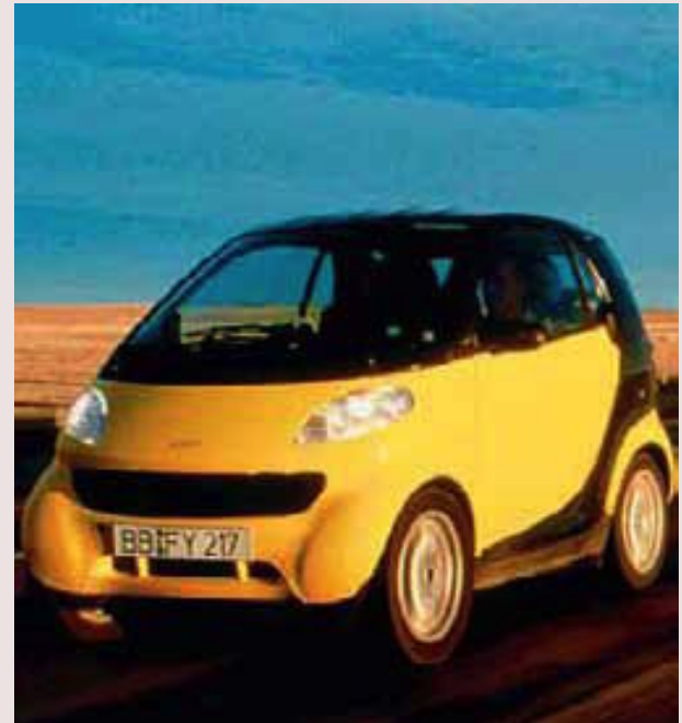
▲ Figura 12.16 Los paneles de la carrocería de este automóvil experimental están hechos de un plástico de policarbonato-polibutileno.
