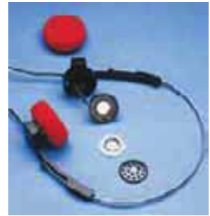
▲ Figura 23.19 Interior de unos audífonos ligeros. El dispositivo puede ser pequeño gracias al magnetismo intenso de la aleación de \text{Co}_5\text{Sm} que se utiliza.
