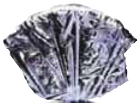
▲ Figura 7.18 Silicio elemental, que es un metaloide. A pesar de su aspecto metálico, el silicio es quebradizo y mal conductor eléctrico y térmico en comparación con los metales. Cristales grandes de silicio se rebanan para formar obleas delgadas que se emplean en circuitos integrados.
