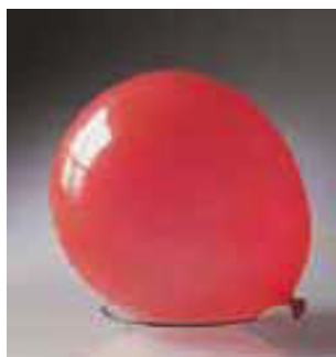
► Figura 10.8 Cuando se vierte nitrógeno líquido ( -196^{\circ}\text{C} ) sobre un globo, el gas que está dentro del globo se enfría y el volumen disminuye.
