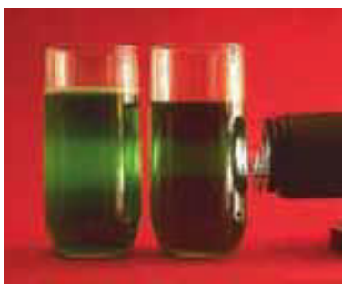
▲ Figura 13.27 Ilustración del efecto Tyndall. El recipiente de la izquierda contiene una suspensión coloidal; el de la derecha, una disolución. El camino del haz luminoso a través de la suspensión coloidal puede verse claramente porque las partículas coloidales dispersan la luz. Las moléculas de soluto individuales de la disolución no dispersan la luz.
