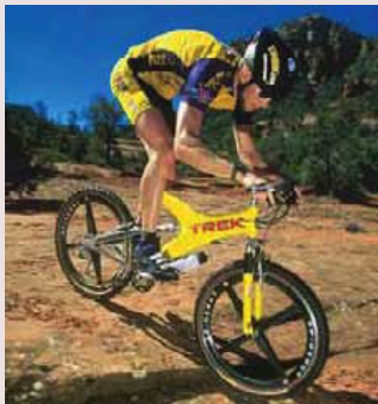
▲ Figura 22.45 Los materiales compuestos (“composites”) de carbón se usan extensamente en aplicaciones aeroespaciales y automovilísticas, así como en artículos deportivos. Esta bicicleta de alto rendimiento (¡y alto precio!) para campo traviesa tiene un armazón de material compuesto de fibra de carbono que la hace muy ligera y ayuda a absorber los golpes.
