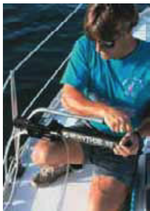
▲ Figura 18.15 Desalinizador manual de agua Survivor-35 de Katadyn North America Modelo MROD-35-LS que funciona por ósmosis inversa. Produce 4.5 L de agua pura por hora a partir de agua de mar.
