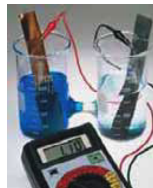
▲ Figura 20.4 Celda voltaica basada en la reacción de la ecuación 20.7. El compartimiento de la izquierda contiene \text{CuSO}_4 1 M y un electrodo de cobre. El de la derecha contiene \text{ZnSO}_4 1 M y un electrodo de zinc. Las disoluciones están conectadas por un disco de vidrio poroso, que permite el contacto entre las dos disoluciones. Los electrodos metálicos están conectados a través de un voltímetro, que lee el potencial de la celda: 1.10 V.
