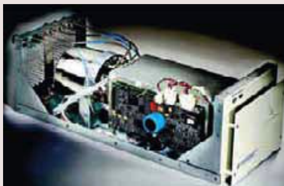
▲ Figura 12.30 Vista de un amplificador que emplea un filtro superconductor para recibir las señales de teléfonos celulares. El objeto cilíndrico de la izquierda es el refrigerador criogénico que mantiene al filtro a una temperatura por debajo de sus valores de T_c .
