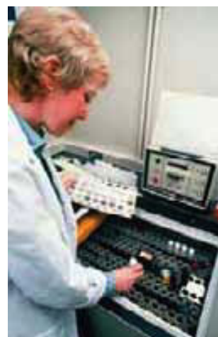
▲ Figura 21.11 Contador de centelleo; se utiliza para medir cuantitativamente el nivel de radiación.
