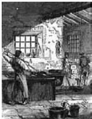
◀ Figura 25.18 Desde hace mucho tiempo se utiliza la saponificación de grasas y aceites para hacer jabón. Este grabado muestra una etapa del proceso de fabricación de jabón a mediados del siglo XIX.
