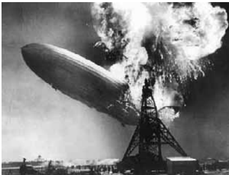
◀ Figura 5.15 El incendio del dirigible Hindenburg , lleno de hidrógeno, en Lakehurst, New Jersey, el 6 de mayo de 1937. Esta fotografía se tomó apenas 22 segundos después de que ocurrió la primera explosión. Esta tragedia hizo que se dejara de usar el hidrógeno como gas de flotación en tales naves. Los dirigibles modernos están llenos de helio, que no flota tanto como el hidrógeno, pero no es inflamable.
