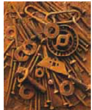
▲ Figura 20.24 Corrosión del hierro en un astillero. La corrosión del hierro es un proceso electroquímico de gran importancia económica. El costo anual de la corrosión metálica en Estados Unidos se estima en 70,000 millones de dólares.
