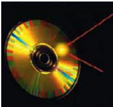
▲ Figura 6.9 Rayo láser reflejado en la superficie de un disco compacto (CD). Los reproductores de CD y otros dispositivos similares utilizan un pequeño haz de luz láser para leer la información del disco.
