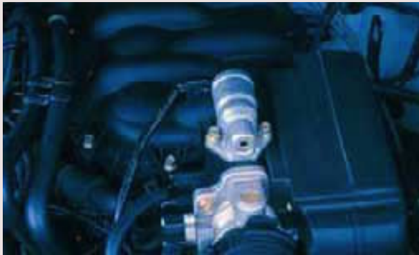
▲ Figura 12.14 El múltiple de admisión de una serie de motores V-8 de la Ford Motor Company está hecho de nylon.
