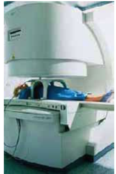
▲ Figura 12.27 Instrumento para obtener imágenes por resonancia magnética (MRI) que se usan en diagnósticos médicos. El campo magnético que el procedimiento requiere se genera por el flujo de corriente en alambres superconductores, que deben mantenerse abajo de su temperatura de transición superconductor, T_c , de 18 K. Esto requiere He líquido como refrigerante.
