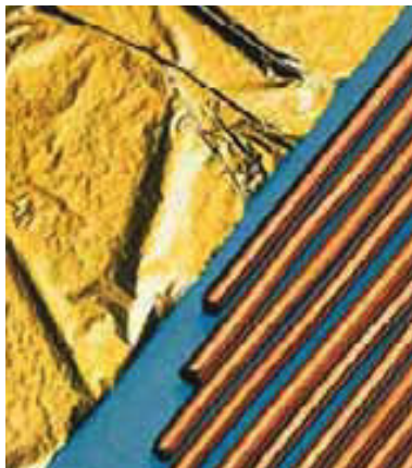
▲ Figura 23.12 La hoja de oro (izquierda) y el alambre de cobre (derecha) demuestran respectivamente la maleabilidad y ductilidad de los metales.
