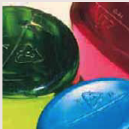
▲ Figura 12.8 Los recipientes plásticos tienen símbolos en su base que indican su composición y su reciclabilidad.
