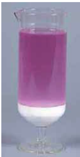
\blacktriangle Figura 22.20 El óxido de bario ( \text{BaO} ), que es el sólido blanco del fondo del recipiente, reacciona con el agua y forma hidróxido de bario [ \text{Ba}(\text{OH})_2 ]. El color púrpura rojizo de la disolución se debe a la fenolftaleína, e indica la presencia de iones \text{OH}^{-} en la disolución.
