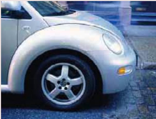
▲ Figura 12.15 Los guardafangos de este Nuevo Beetle están hechos de General Electric Noryl GTX, un material compuesto hecho con nylon y éter de polifenileno.
