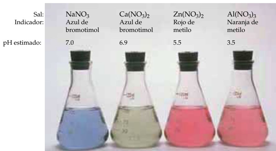
▲ Figura 16.16 Valores de pH de disoluciones 1.0 M de una serie de sales de nitrato, estimados mediante indicadores ácido-base. De izquierda a derecha: NaNO 3 , Ca(NO 3 ) 2 , Zn(NO 3 ) 2 y Al(NO 3 ) 3 .
