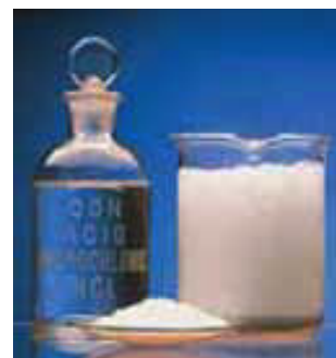
▲ Figura 4.9 Los carbonatos reaccionan con ácidos para formar dióxido de carbono gaseoso. Aquí \text{NaHCO}_3 (sólido blanco) reacciona con ácido clorhídrico; las burbujas contienen \text{CO}_2 .
