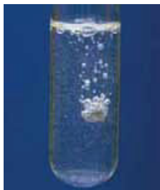
▲ Figura 7.25 El calcio metálico reacciona con agua para formar hidrógeno gaseoso e hidróxido de calcio acuoso, \text{Ca}(\text{OH})_2(ac) .
