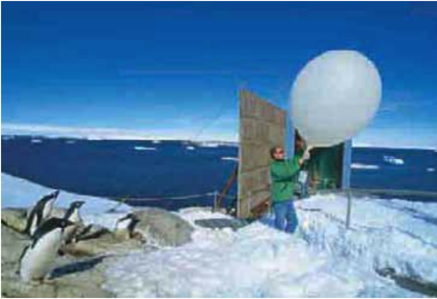
◀ Figura 10.5 El volumen de gas en este globo meteorológico aumentará al ascender a las regiones altas de la atmósfera, donde la presión atmosférica es menor que en la superficie terrestre.
