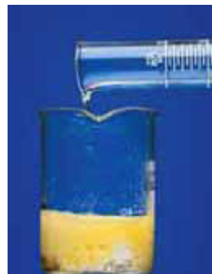
▲ Figura 22.46 El \text{CaCO}_3 sólido reacciona con una disolución de ácido clorhídrico con desprendimiento de \text{CO}_2 gaseoso, que aquí se observa en forma de burbujas en el vaso.
