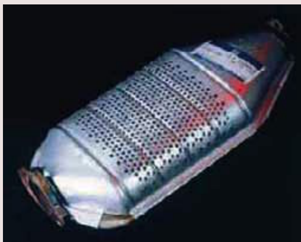
► Figura 14.22 Convertidor catalítico de acero inoxidable que se utiliza en automóviles. El convertidor contiene catalizadores que favorecen la conversión de los gases de escape en \text{CO}_2 , \text{H}_2\text{O} y \text{N}_2 .
