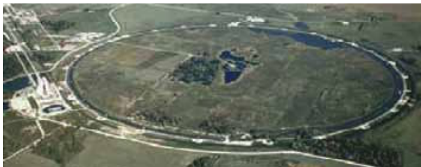
◀ Figura 21.6 Vista aérea del Laboratorio del Acelerador Nacional Fermi de Batavia, Illinois. Las partículas son aceleradas hasta energías muy grandes haciéndolas circular a través de los imanes del anillo, cuya circunferencia es de 6.3 km.
