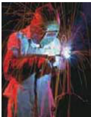
▲ Figura 22.17 Soldadura con soplete oxiacetilénico. El calor de combustión del acetileno es excepcionalmente grande, por lo cual se alcanza una temperatura de llama muy alta.
