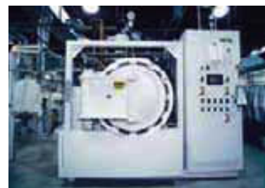
▲ Figura 18.20 Este aparato para lavado en seco emplea \text{CO}_2 supercrítico como disolvente.
