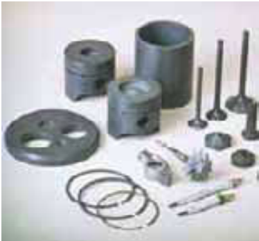
▲ Figura 12.23 Diversas piezas cerámicas hechas con nitruro de silicio, Si 3 N 4 . Estos componentes cerámicos pueden reemplazar a piezas metálicas en motores o utilizarse en otras aplicaciones que impliquen altas temperaturas y mucho desgaste. (Utilizado con autorización de Kyocera Industrial Ceramics Corporation.)
