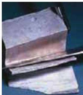
▲ Figura 7.19 El sodio y los demás metales alcalinos son tan blandos que se pueden cortar con una navaja. La brillante superficie metálica pronto se opaca porque el sodio reacciona con el oxígeno del aire.
