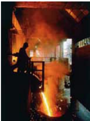
▲ Figura 6.5 El color y la intensidad de la luz emitida por un objeto caliente depende de la temperatura del objeto. La temperatura es máxima en el centro de este vaciado de acero fundido. Por ello, la luz emitida por el centro es más intensa y tiene longitud de onda más corta.
