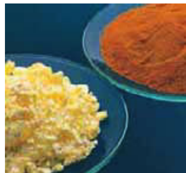
▲ Figura 2.25 Los compuestos de iones del mismo elemento pero con diferente carga pueden tener una apariencia muy distinta. Las dos sustancias que se muestran aquí son sales de hierro con iones \text{K}^+ y \text{CN}^- . La de la izquierda es ferrocianuro de potasio, que contiene Fe(II) unido a iones \text{CN}^- . La de la derecha es ferricianuro de potasio, que contiene Fe(III) unido a iones \text{CN}^- . Ambas sustancias se utilizan mucho en procesos de impresión y teñido.
