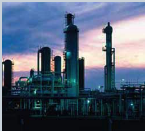
▲ Figura 13.21 Torres de destilación industriales, en las que los componentes de una mezcla orgánica volátil se separan según su intervalo de punto de ebullición.
