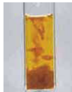
▲ Figura 23.30 La adición de una disolución de \text{NaOH} a una disolución acuosa de \text{Fe}^{3+} provoca la precipitación de \text{Fe}(\text{OH})_3 .
