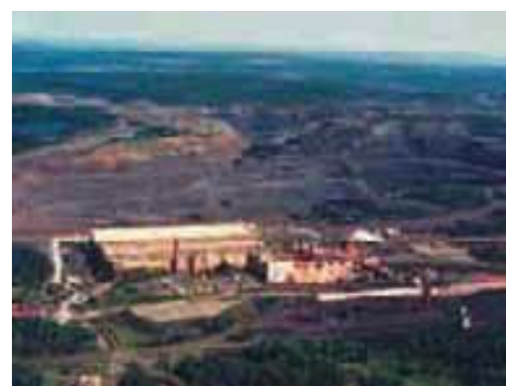
▲ Figura 23.3 En esta mina de mena de hierro a cielo abierto de la Península Superior de Michigan, la mena cruda se concentra y se moldea en gránulos para el transporte.
