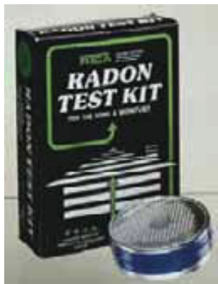
▲ Figura 21.25 Equipo casero para ensayo de radón. Equipos de esta clase están disponibles para medir los niveles de radón en casa.
