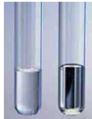
▲ Figura 11.16 Comparación entre el menisco del agua y el del mercurio en un tubo similar.
