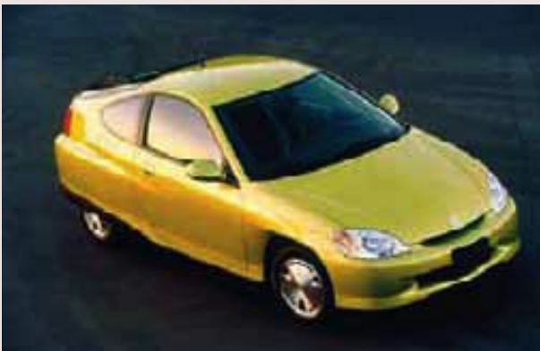
▲ Figura 5.25 El Honda Insight, un automóvil híbrido en el que la potencia para impulsar el vehículo y sus accesorios proviene tanto de baterías como de un motor de gasolina.
