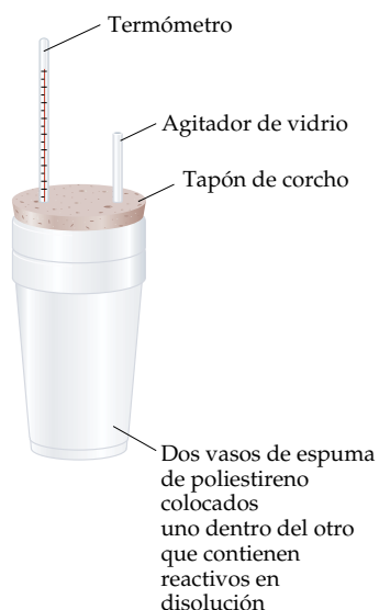
▲ Figura 5.18 Calorímetro de vasos para café, en el que se efectúan reacciones a presión constante.
