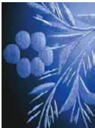
▲ Figura 22.13 Vidrio grabado o escarchado. Diseños como éste se producen recubriendo primero el vidrio con cera. Después se quita la cera de las áreas por grabar. Al tratarlas con ácido fluorhídrico, las áreas expuestas del vidrio son atacadas y se produce el efecto de grabado.
