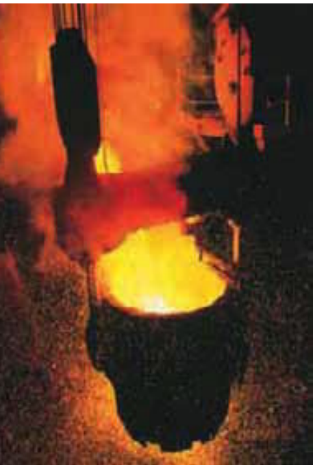
▲ Figura 23.5 Vertido del hierro fundido para su transporte a un convertidor de oxígeno básico. Los fabricantes de acero convierten el hierro en acero agregando chatarra y otros metales como agentes de aleación.
